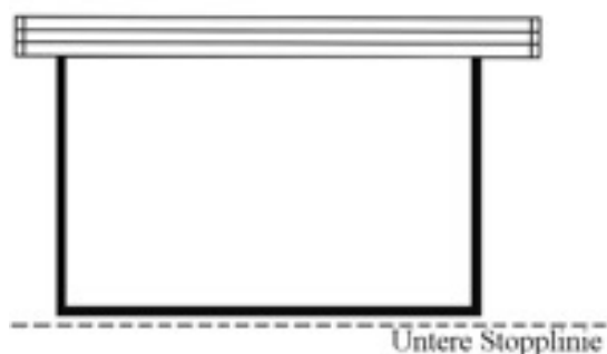
Untere Stopplinie nach dem Ausrollvorgang.
